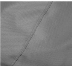
Reforço Costura dupla com linha resistente a grandes esforços.
