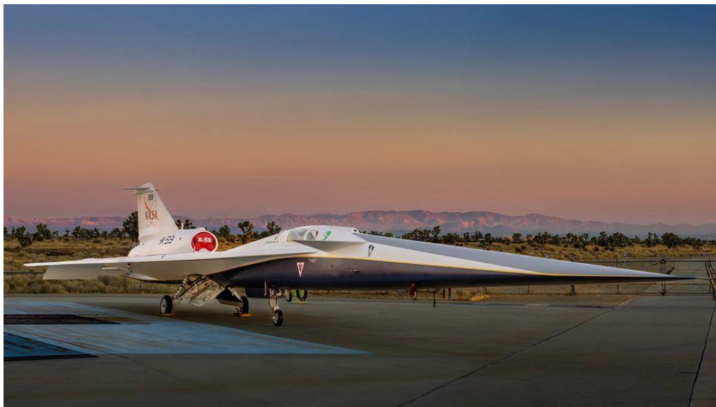
Figura 2 – O X-59, primeiro avião supersônico silencioso, foi mostrado ao público em Palmdale, Califórnia, no dia 12 de janeiro de 2024 . Deve voar a 1.500 km/h (Mach 1,4) em altitudes de até 16 km. Segundo a Nasa, o X-59 deve realizar o seu primeiro vôo até o final deste ano. Crédito: Lockheed Martin Skunk Works
