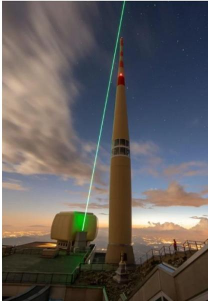
**Figura 8** Segundo harmônico (515 nanômetros) gerado por laser pulsado de Yb:YAG, induzindo raios a caírem na torre de telecomunicações de 124 metros de altura na montanha Säntis (Suíça).
