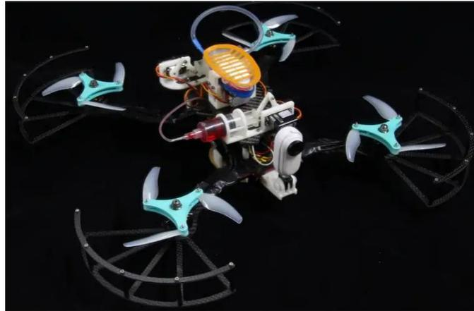
**Figura 4** As hélices do drone são articuladas permitindo que ele aumente as rotações para voar no ar ou diminua, para navegar na água. Tem 40 cm de diâmetro e esse protótipo pode mergulhar até 2,2 metros. Fonte: Lei Li, Yiyuan Zhang e Nianru Mo
