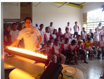
Chamas Dançantes: Determinação da Velocidade do Som através de um tubo com gás e um gerador de áudio, na EMEB Artur Natalino Deriggi, no dia 5 de outubro de 2005, São Carlos – SP.
